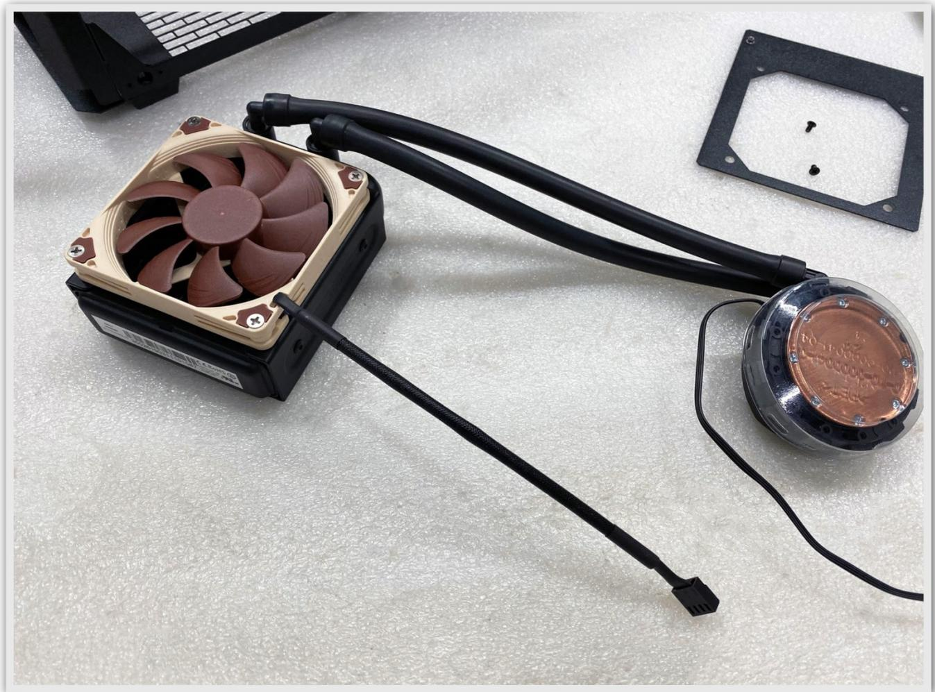
**HINWEIS:** Sliger Designs inkludiert **KEINE** Schrauben für Montage von Lüfter auf den Radiator. Wir empfehlen 4x .750" lange 6-32 Phillips #2 Flachkopfschrauben.
